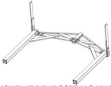
MONTAJE DEL POSTE Y GABLETE A PARTIR DE LOS PASOS ANTERIORES
